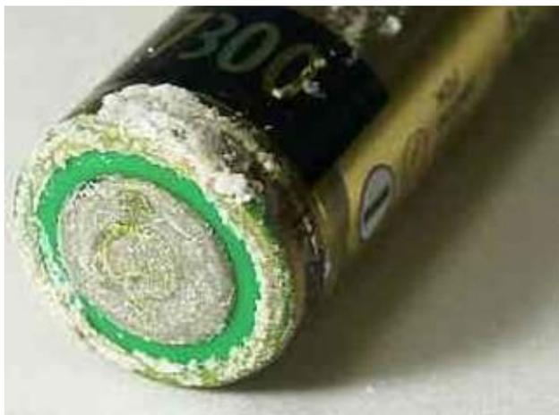
マンガン乾電池の場合、漏れた電解液は無色ですが、電池端子の銅成分で緑青色や、スプリング電池端子の鉄成分で赤茶色の水溶液です。
