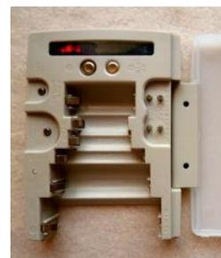
バッテリーチェッカーには色々な方式があり、100均のアナログ電流計方式のものは、電池から負荷抵抗に電流を流し、その電流を**電池消耗の目安目盛り**がついたアナログ電流計で表示します。**電子方式**のものは、電池から負荷抵抗に電流を流すのは同じですが、電池消耗を**LEDの色やLEDで投影した文字**で表示します。
