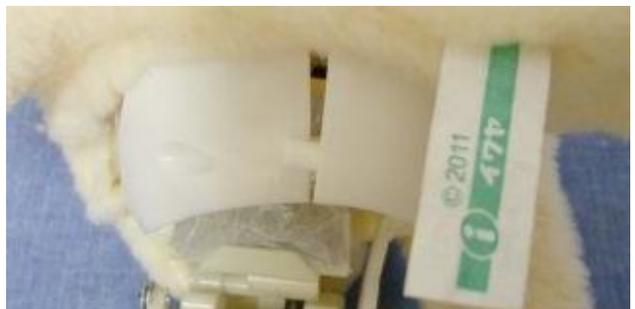
頭部左右を戻して合わせ、後頭部左下のネジ (タッピング 2. 4×5) 1本を留めます。
