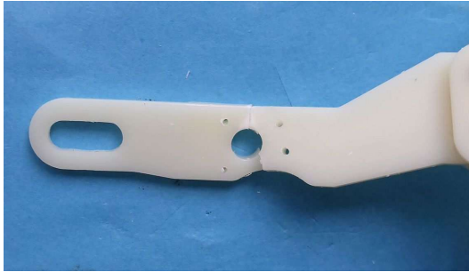
ステンレス線を通す穴を開けておく
