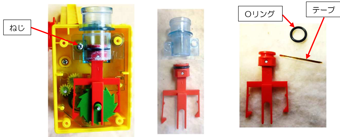
ピストン部の修理方法
