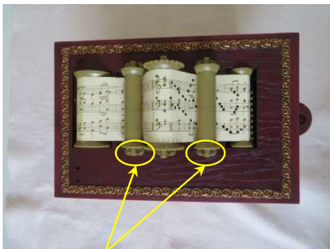
片側の軸受けを外すとローラーが取れる
