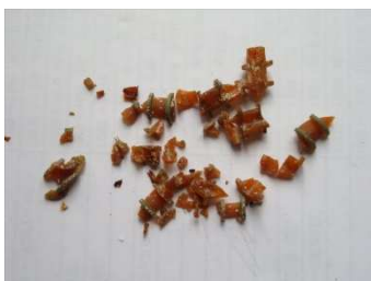
経年劣化で破損した樹脂部品
