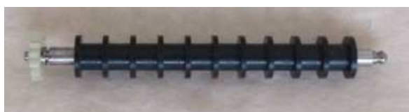
再生した部品を圧入したシート送りローラー
