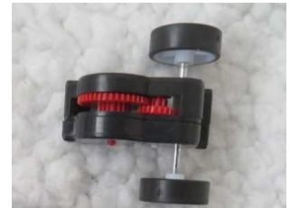
DAISOミニカーのエンジン（ギアボックス）
