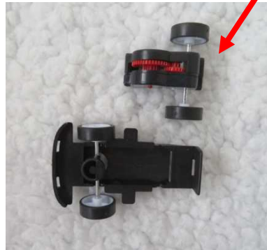
DAISOミニカーのエンジン（ギアボックス）
