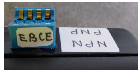
〔トランジスタ測定端子の表示〕 裏面
