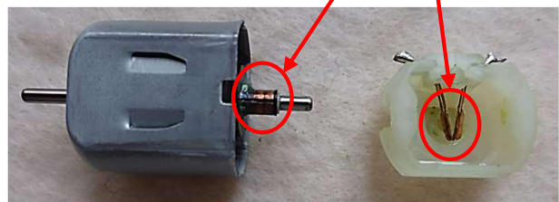
分解したモーターのブラシ部の汚れ
