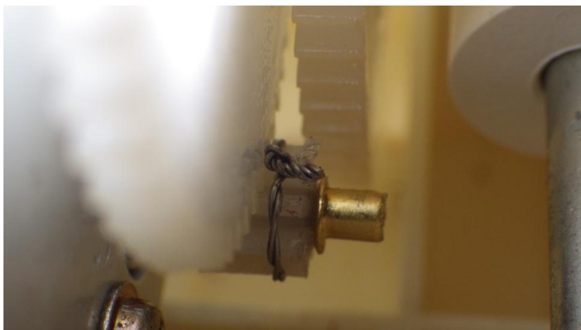
写真3. 2mm のハトメを割いて，取り付け強度を強化
