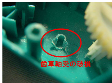
別部分の軸受破損
