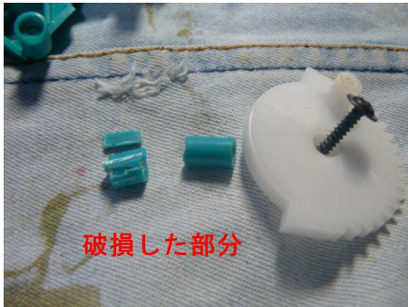
問題の軸受破損断片
