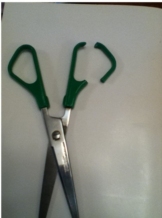
写真1 指を入れる部分のプラスチックが折れたハサミ
